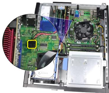
4. イントルージョンスイッチをシャーシの底に向かってスライドさせ、システム基板から取り外します。
