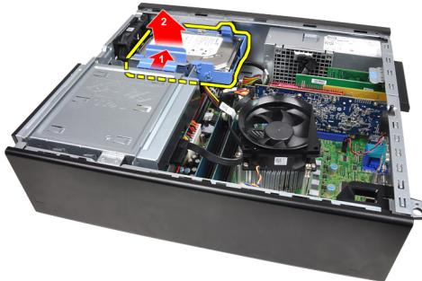
5. ハードドライブブラケットを曲げ、3.5インチハードドライブ1台または2.5インチハードドライブ2台をブラケットから取り外します。
