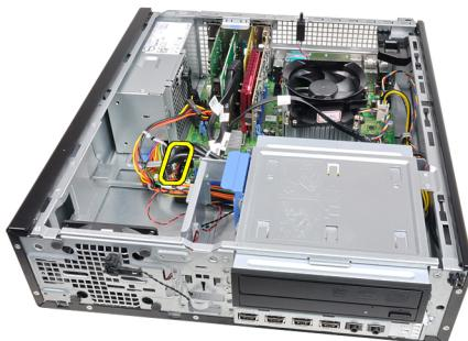
5. 入力/出力パネルをコンピューターに固定するネジを外します。
