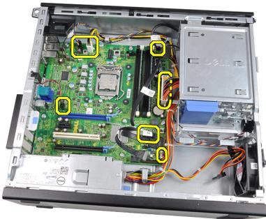
8. 拡張カードラッチを持ち上げて解除し、システム基板を固定しているネジにアクセスします。
