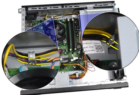
6. 4つのハトメに内側にスライドし、コンピューター前面のスロットに通します。
