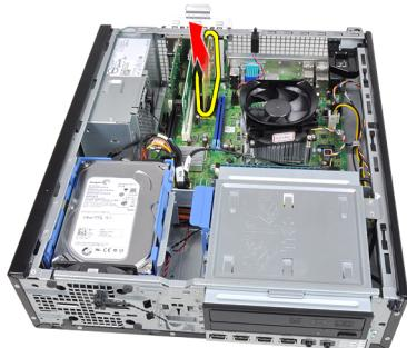
6. PCI 拡張カードをコネクターから持ち上げて外し、コンピューターから取り外します。
