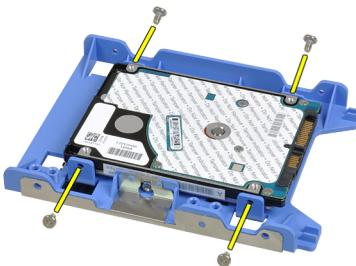
8. 2.5インチハードドライブをハードドライブブラケットの上面に固定しているネジを緩めます。
