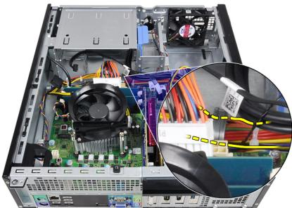
8. 電源ユニットをコンピューターの背面に固定するネジを取り外します。
