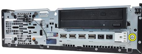
6. 入力/出力パネルをシステムの右側にスライドさせ、シャーシから取り外します。
