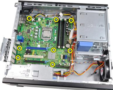
10. システム基板をコンピューターの前面に向かってスライドさせます。
