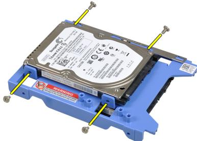
7. ハードドライブブラケットを曲げ、2.5インチハードドライブ2台をブラケットから取り外します。
