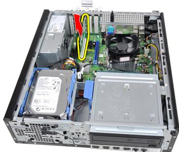
7. PCI x4 拡張カードをコネクターから持ち上げて外し、コンピューターから取り外します。
