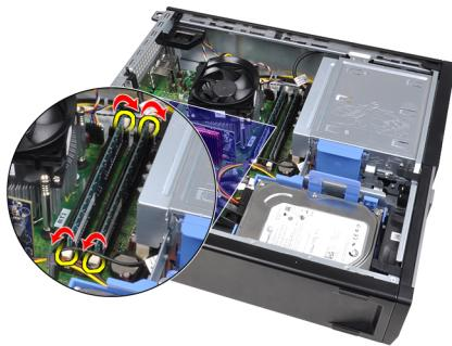
4. メモリモジュールを持ち上げながら、システム基板上のコネクターから取り外します。
