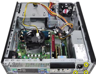
9. 電源ユニットのそばにある青いリリースタブを押し、電源ユニットをコンピューターの前面に向かってスライドさせます。
