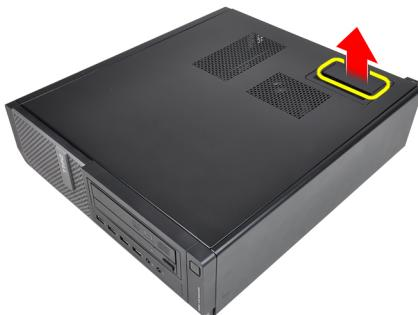
3. カバーを 45 度の方向に持ち上げ、コンピューターから取り外します。
