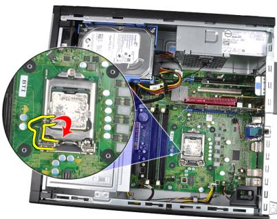
8. プロセッサーを持ち上げてソケットから取り外し、静電防止パッケージに入れます。
