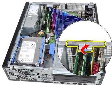
4. カードのくぼみから固定タブが解除されるまで、PCIe x16 カードからゆっくりリリースレバーを引っ張ります。次にカードをコネクターから持ち上げて外し、コンピューターから取り外します。
