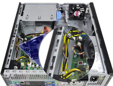
6. 24 ピン電源ケーブルをシステム基板から取り外します。
