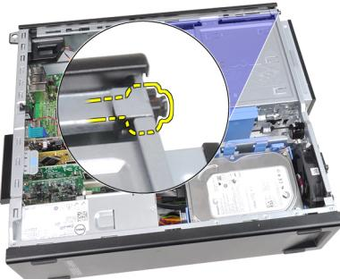
6. 電源スイッチケーブルをスライドしてコンピューターの前面から取り外します。
