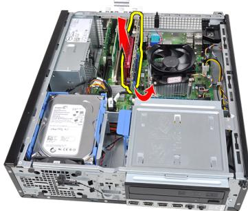
5. PCIe x1 拡張カードをコネクターから持ち上げて外し、コンピューターから取り外します。
