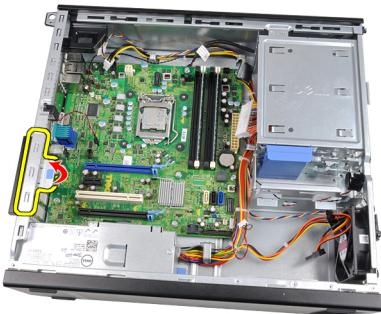
9. システム基板をシャーシに固定しているネジを外します。
