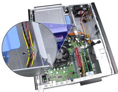
5. スピーカー固定タブを押し、スピーカーを上向きにスライドさせながら取り外します。
