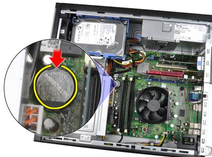
4. コイン型電池を持ち上げながら、コンピューターから取り出します。
