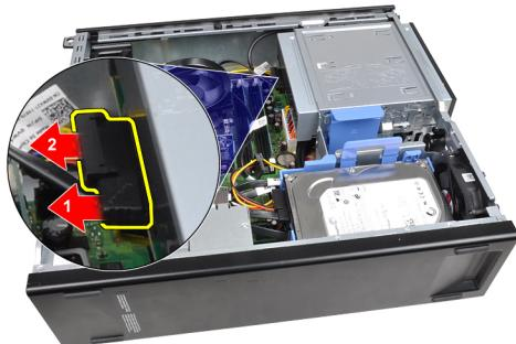
5. オプティカルドライブのラッチを上向きにスライドさせ、コンピューターの背面から前面に向かってオプティカルドライブを押し出します。
